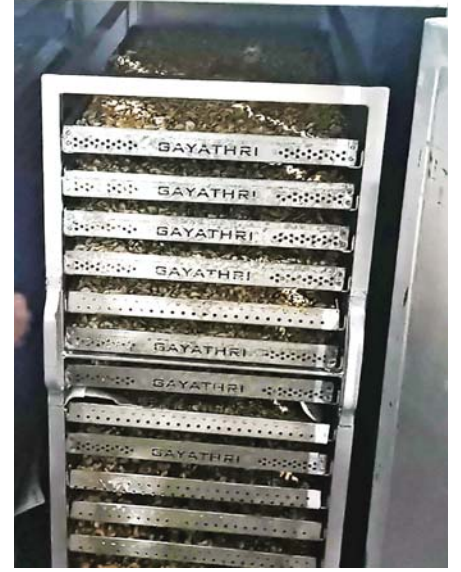
பல அடுக்கு உள்ள தட்டுகளில் வைக்கப்பட்டு ஈரப்பதம் நீக்கப்படும் முறை
